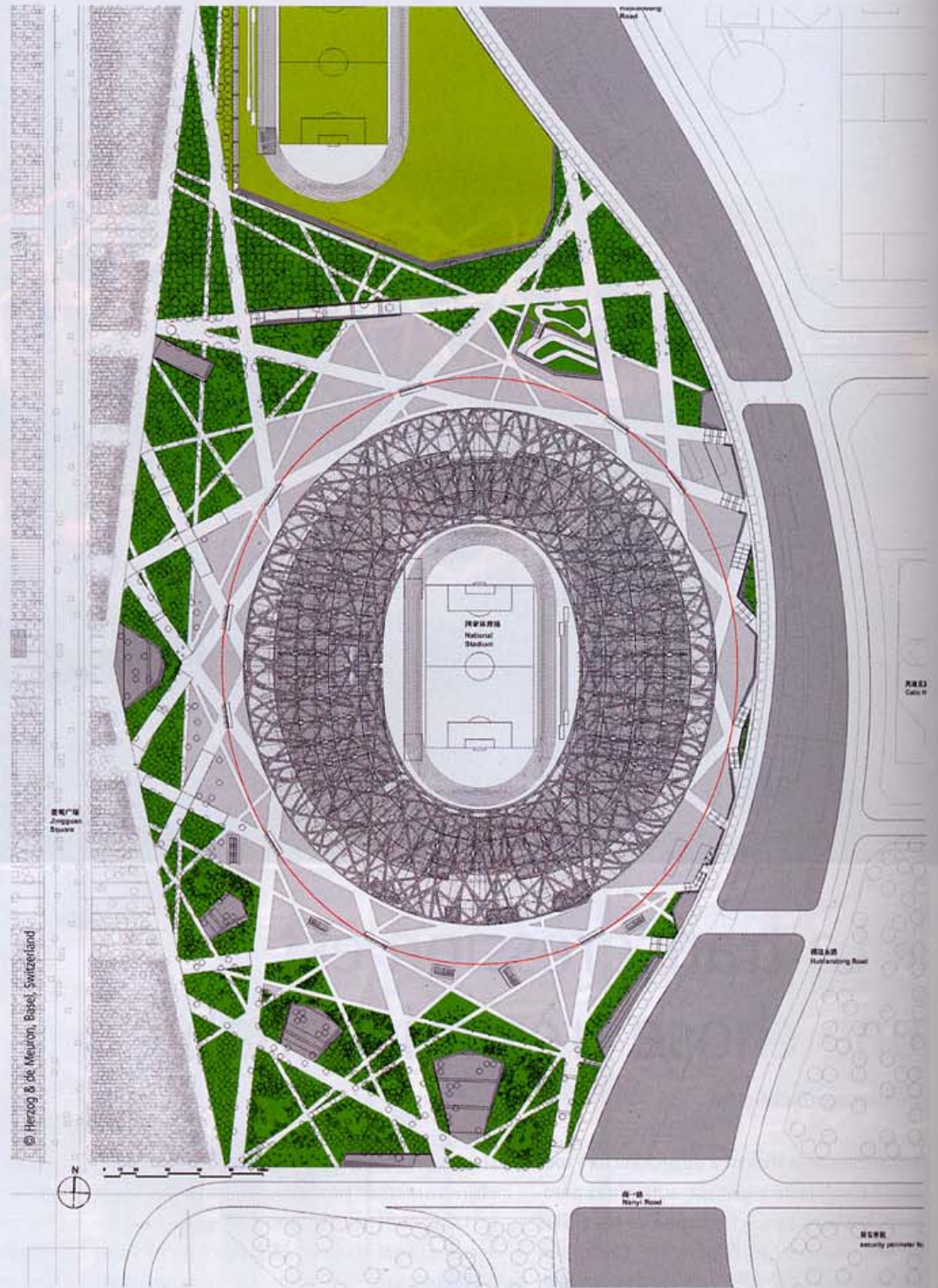
△ Plan masse montrant la maille structurelle en toiture. ▽ Coupe transversale.
